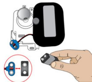
Connectez la pile. Un bip retentit lorsque la pile est correctement connectée.
