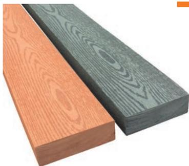
Le bois technologique ou WPC (Wood Plastic Composite) est un composé mélange de fibres de bois et de polymères avancés qui proviennent du recyclage, unis entre eux dans une matrice à laquelle des agents stabilisateurs et des mastics sont incorporés. Densité: 1270 Kg/m<sup>3</sup>.
