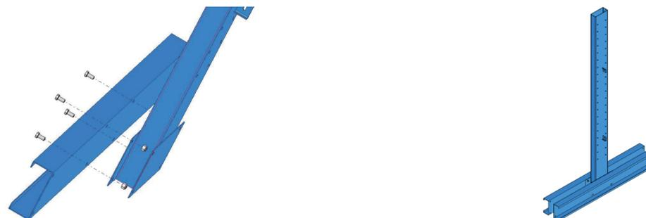
Visser les platines de fixation. (2 vis H M12 x 20 + écrous frein)
