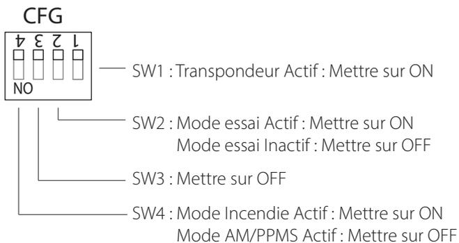
\*Mettre SW4 sur la position adaptée à votre utilisation suivant le paragraphe «COMPATIBILITÉ»
