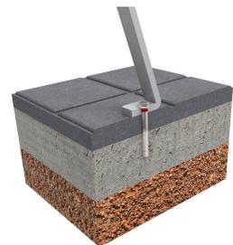
Ancrage recommandé : au moyen de boulons à expansion M10 en fonction de la surface et du projet.
