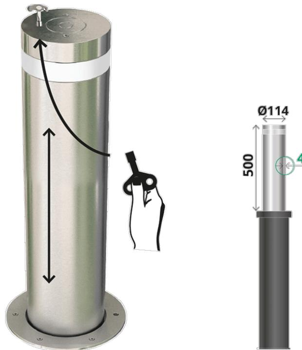
Borne conçue pour contrôler les accès sur la voie publique et dans les copropriétés, entreprises, etc. Piston en acier inoxydable AISI 304 satiné de Ø220 x 500mm de hauteur. Couvercle, châssis, attaches et visserie en acier inoxydable. Elévation automatique, facile et rapide, descente manuelle. Blocage automatique dans les deux positions, déblocage au moyen d'une clé triangulaire DIN3223.
