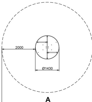
**Structure, Métal** : acier galvanisé à chaud et thermolaqué résistant à la corrosion. Coloris : RAL 6018, RAL 1028.
