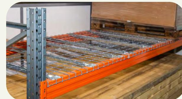
Plateaux fils, maille 60x100/125 mm, 2 bords tombés avec découpe de 180 mm pour passage butée podium, 3 renforts OMEGA.
