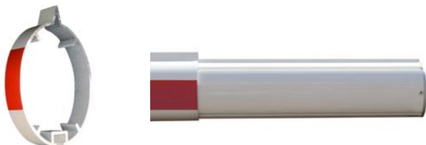
Profilé extrudé 115 x 85 mm • Extrêmement robuste - Testé avec barrière d'accès 4 M chargée à 600 kg en partie centrale • Equipé en partie supérieure avec une protection anti-assise de 13 mm et en partie inférieure avec une rainure pour vis avec une clé d'ajustage • Stabilisation supplémentaire par câble de tension à partir de 5,5 M • Laquage ÉPOXY de haute qualité en RAL 9010 HR (blanc semi mat) • Avec plusieurs bandes réflectos rouges de 0,5 m 3MTM
