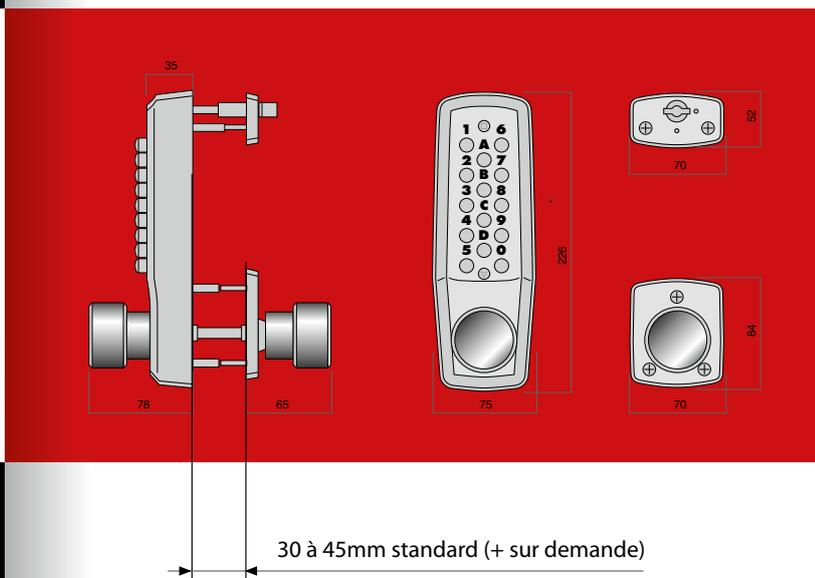
Ensembles à code sur serrure spéciale de type européen fournie (axe à 50 mm, pêne 1/2 tour et pêne dormant, pour cylindre européen)
