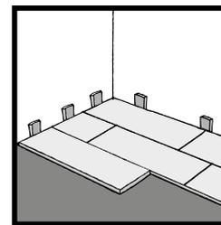
c. Lors de la pose de lames, veiller à ce qu'un décalage des panneaux de tête d'au moins 15 cm soit observé.
