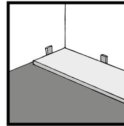
a. Découper le revêtement de sol et laisser un écart de 2 mm maximum avec les murs et tous les éléments fixes (encadrements de porte, tuyaux de chauffage, etc.).
