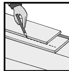
d. Lors de la coupe de ladernière rangée d'éléments, observer une distance mur d'au moins 2 mm ! - Éliminez **toutes** les entretoises du mur ! L'écartement du mur est recouvert d'une plinthe. Veuillez dans ce cas à ce que la dilatation du sol ne soit pas entravée par la plinthe.
