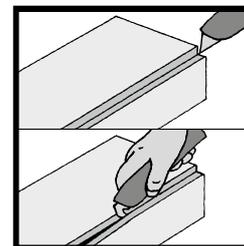
b. Le revêtement de sol se coupe avec une lame trapézoïdale du côté de sa surface supérieure, la sous-couche de fibre de verre de renforcement ou la sous-couche lourde en bitume des lames de moquette doivent être ensuite découpées avec une lame croche.
