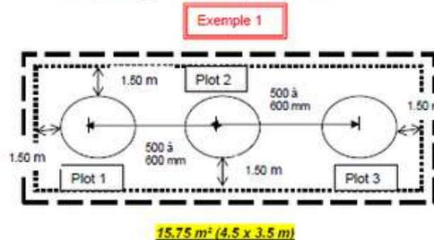
**Niveau zéro :** La hauteur du plot se mesure à partir de la base de son pied. Le sol amortissant correspondant devra donc être placé jusqu'à atteindre la base du pied.
