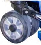
Roues caoutchouc montées sur axe oscillant pour réduire les efforts de roulage et assurer la stabilité de la charge transportée.
