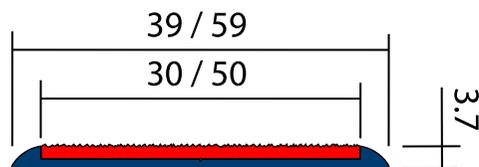
Le dispositif permettant le repérage visuel et la mise en sécurité des nez de marches par leur mise en contraste et leur traitement non-glissant sera un nez de marche plat à visser de 1150, 1500, 2305 ou 3005 mm de longueur, 39 ou 59 mm de largeur et de 3,7 mm d'épaisseur de type PASSAGE by PROOPLE NP3AM (largeur 39 mm) ou NP5AM (largeur 59 mm) ou équivalent.
