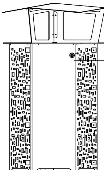
Système de verrouillage par serrure à clé
