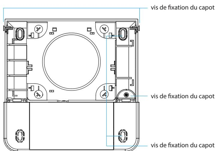
Fixer le coffret sur le mur en prenant soin de laisser accessible le système de fermeture du capot.
