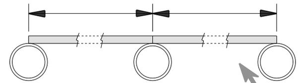
bord des tôles de toiture dans l'axe des armatures
