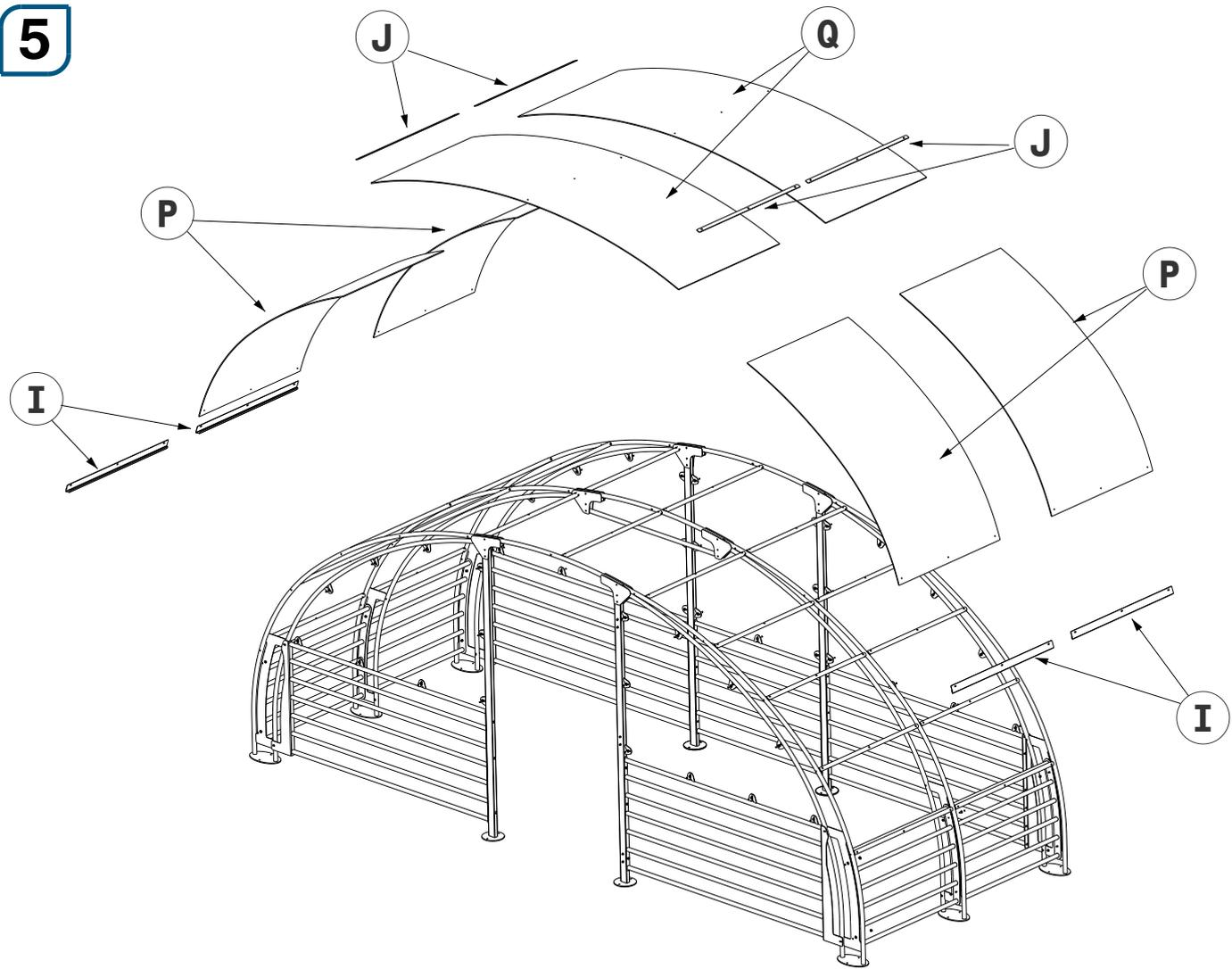
Toiture centrée sur la longueur et la largeur de l'abri
