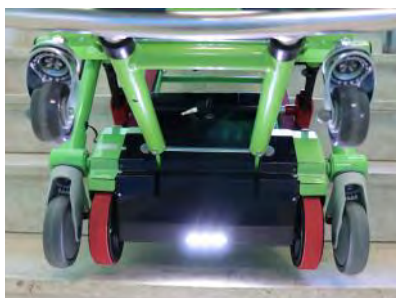
Eclairage des marches par LED
