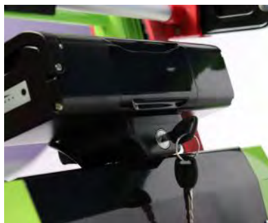
Clé de verrouillage batterie
