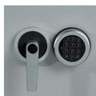
Serrure de coffre-fort classe 2 VDS, 1 000 000 de combinaisons alphanumériques, intâtable, temporisée après la 3<sup>e</sup> erreur. 1 code maître et un code utilisateur programmables. Condamnation automatique à la fermeture de l'armoire. Alimentation par pile avec système extérieur de secours.
